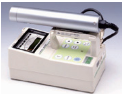
図2 NaI(Tl) シンチレーションサーベイメーター (アロカ社製 TCS-171)
