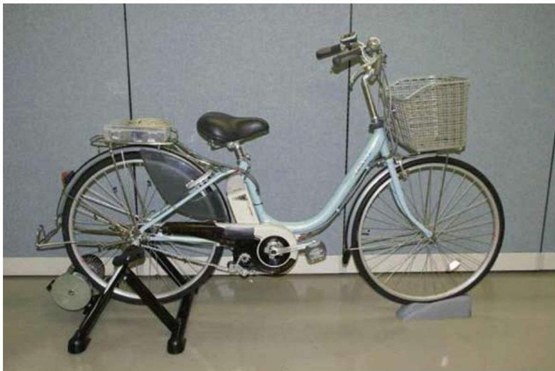
図3 電動アシスト自転車と負荷固定装置
