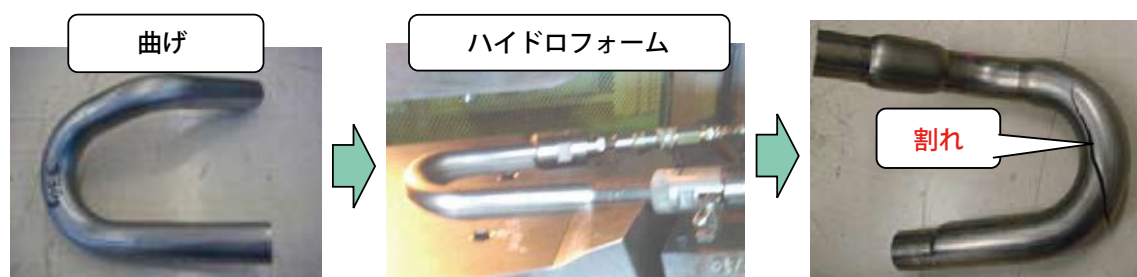
図7 ハイドロフォーム加工時の不具合
