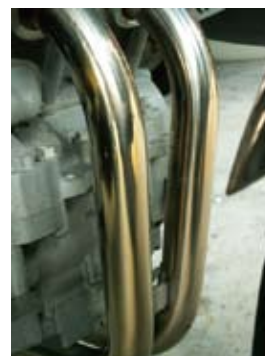
写真：約4万km走行車両 (TDM-900) 変色・錆び発生無し
