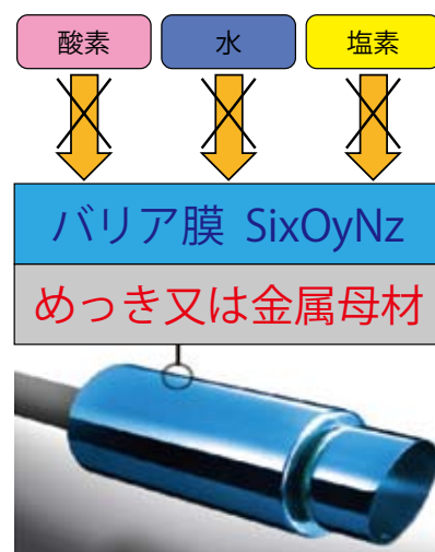
図3 ガスバリア膜による変色・錆び防止のメカニズム
