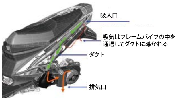
図2 ベルト冷却方式のコンパクト化
