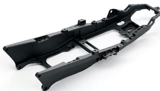
図1 2008年モデル YZF-R6 に採用された マグネシウムリアフレーム
