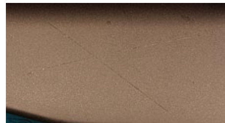
図 13 下地処理と塗装を行った CF マグネシウムダイキャスト材の塩水噴霧試験後の外観
