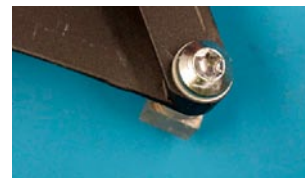
図 14 塩水噴霧試験後の締結部外観
