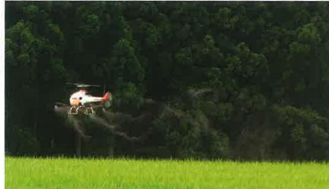
図3 機体後方に後流渦を引く様子
