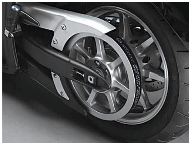
図 10 美しくデザインされたベルトドライブプーリー
