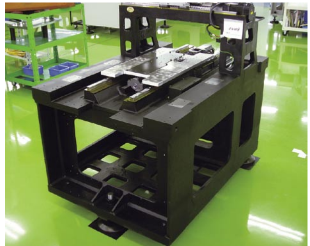
図5 3本足で支持された一体構造高剛性鋳造ベッド
