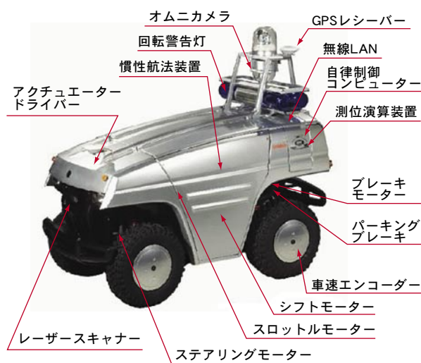
図3 UGV搭載の制御装置
