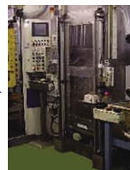
新解凍機 (設備幅1m、ワーク6本滞留)
