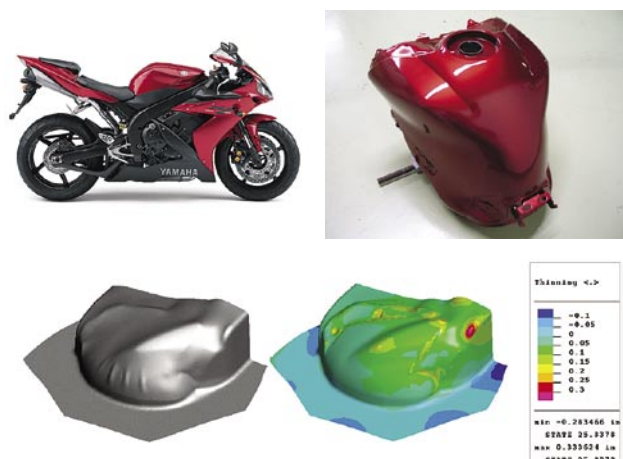
図9 YZF-R1(2004) 車体とタンク、解析結果画像
