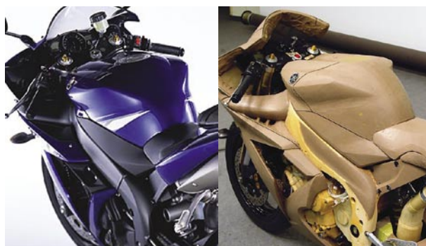
図 8 New YZF-R1（左）とクレイモデル（右）
