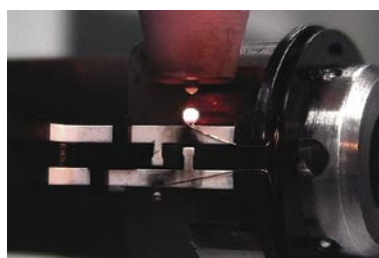
図3 電線と端子の抵抗溶接
