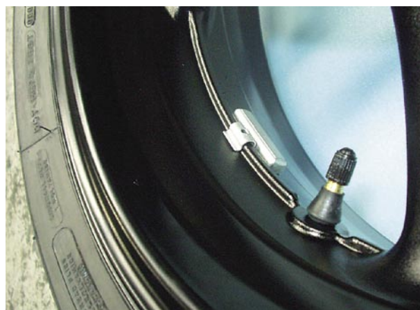
図1 キャストホイールへの組付け例
