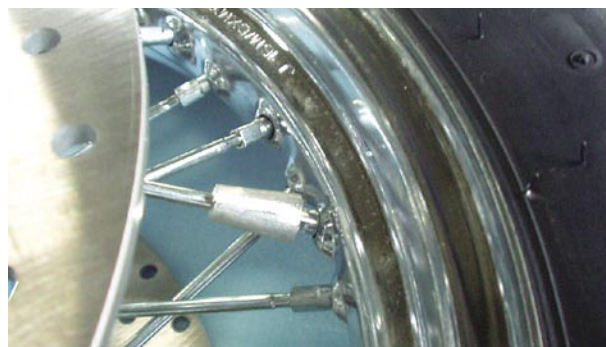
図 8 スポークホイールへの組付け例
