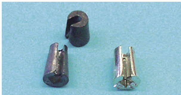
図 6 バランス（左：鉛製 右：スズ製）
