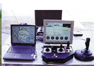
地上局 (地上管制装置)
