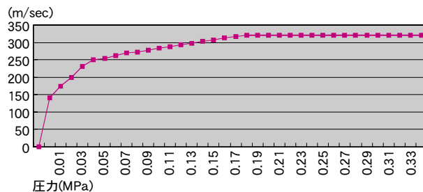
図4 圧縮エアの臨界速度
