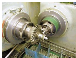
図9 噛合わせ検査による歯当り評価
