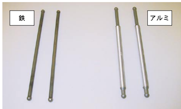
図5 プッシュロッドのアルミ化
