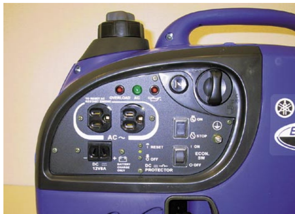
図8 片面集中コントロールパネル
