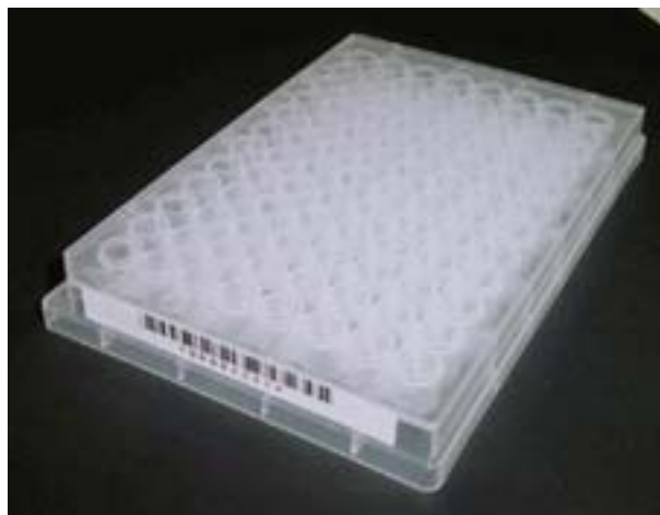
図3 96 ウェルマザープレート 外観サイズ：85 × 127 × 14mm 材質：PP
