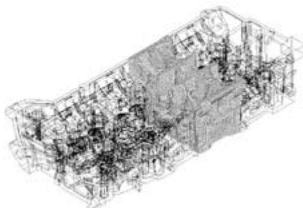
図10 シリンダーヘッド熱伝導解析用 FEM モデル (一部)
