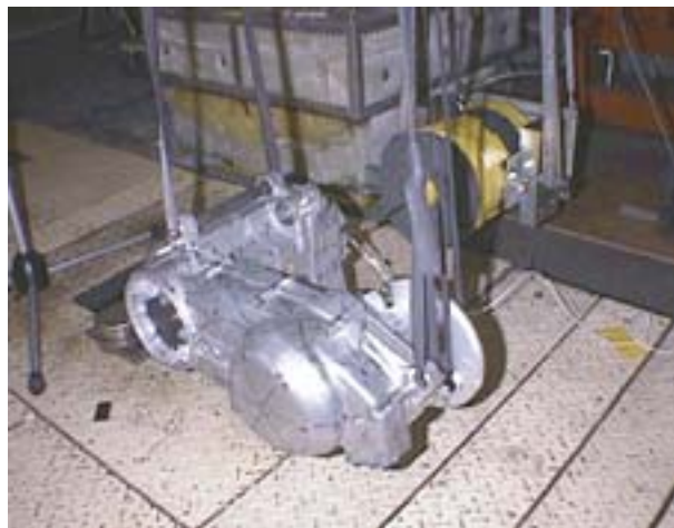
図5 実験：ボイドエンジン Shaker 加振
