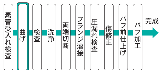
図2 エキゾーストパイプの製作工程
