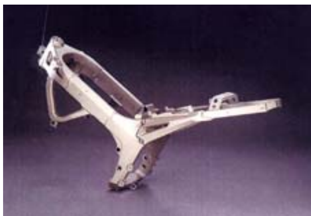
図 10 軽量高剛性アルミフレーム
