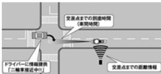
図8 右直事故防止システムの概念図
