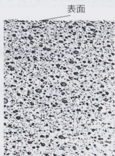
図6 スイコミ不良が発生していない素材の断面
