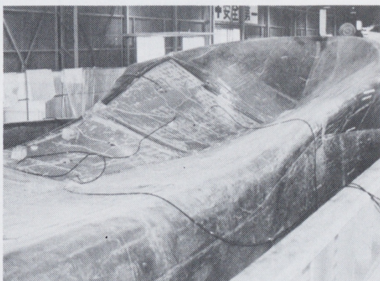
写真5 センターハルのサンドイッチ芯材接着作業
