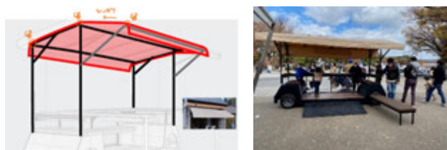
図7 V2: ルーフ・テーブル軽量化・簡素化、設置性向上に対応した改良
