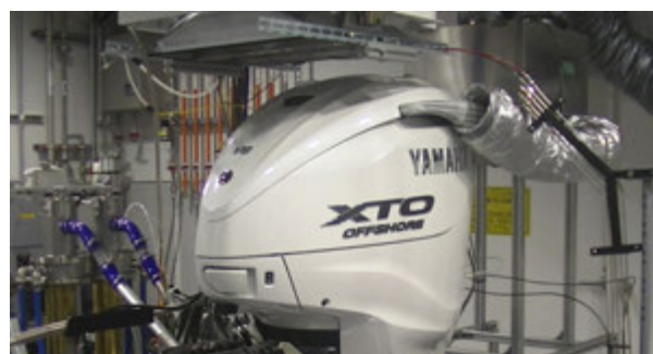
図5 水素船外機台上試験
