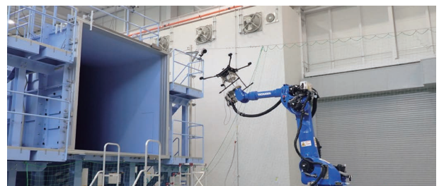
図5 機体抵抗試験の様子
