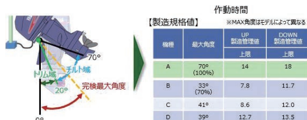
図8 作動時間の製造規格値(単位:秒)
