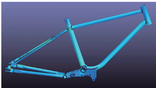
図2 フレームの応力解析モデル
