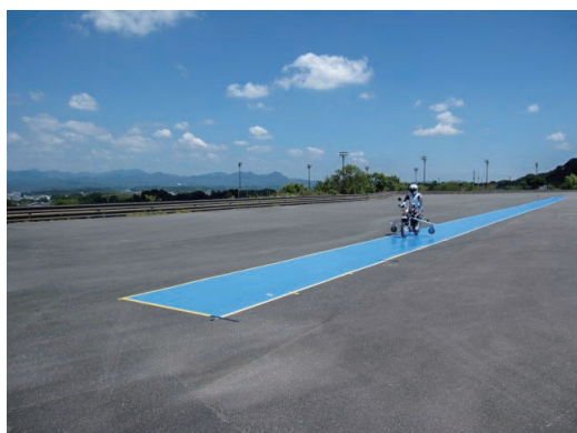
図2 実機による \mu - \lambda 特性計測試験
