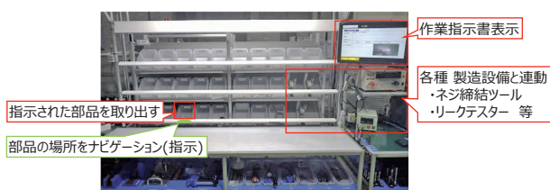
図8 実際に導入したプロジェクションアッセンブリーシステムを用いた組立工程
