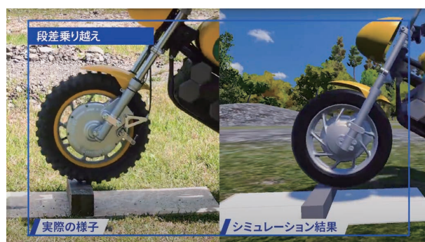
図7 段差乗り越しシミュレーション 実機との比較
