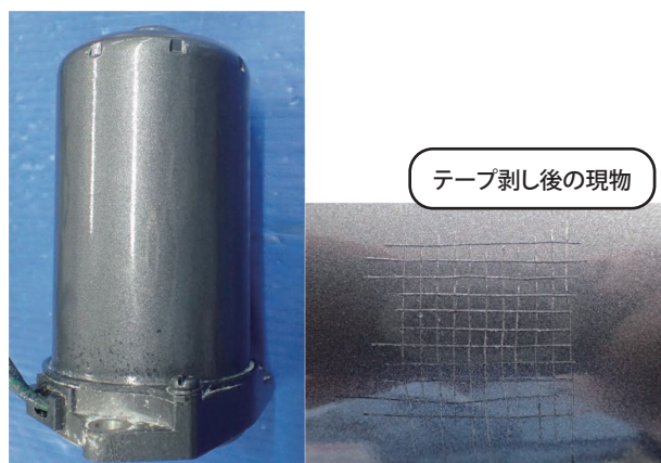
図9 評価終了時状態 (左: 耐食性、右: 密着性)
