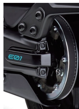
図8 後輪のベルトドライブ構造
