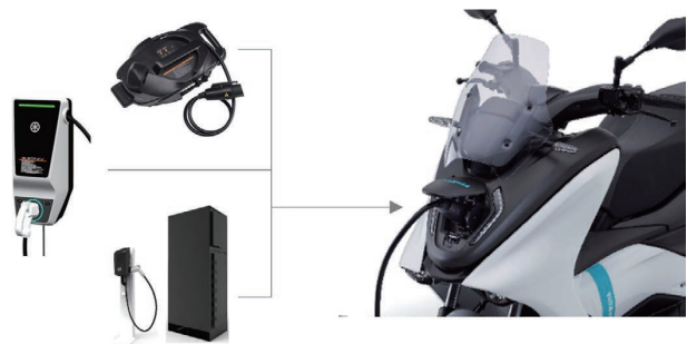
図4 IEC 62196-6規格のコネクタを採用 接続部を共通化することで様々なタイプの充電器 利用できるようにした
