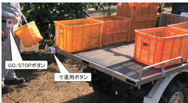
図16 寸進用ボタンと GO/STOP ボタン
