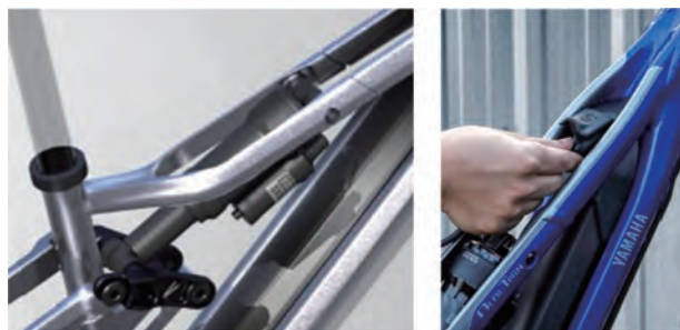
図2 異なる工法で構成したツイントップチューブ
