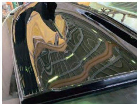
図16 完成したハルメ型。表面が鏡のようになるまで磨き上げる。
