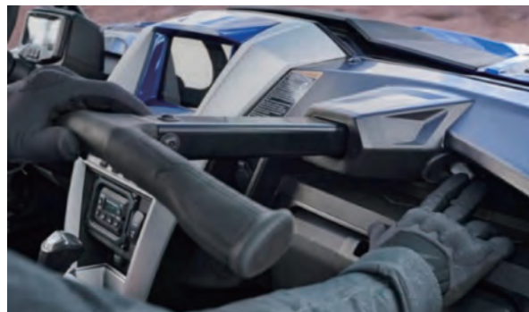
図9 多段階調整のパッセンジャーアシストグリップ
