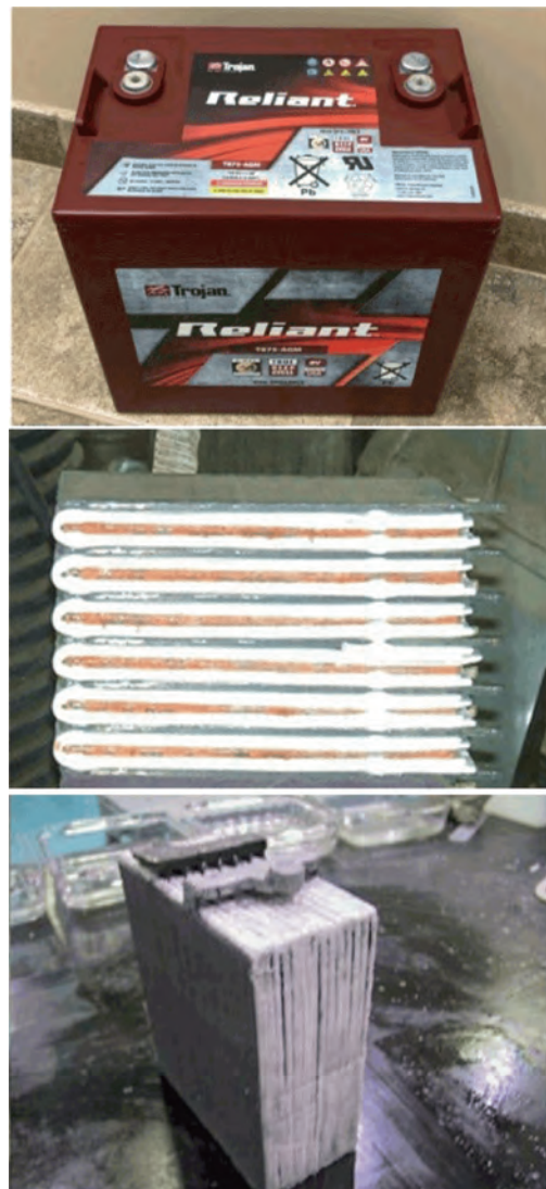
図2 AGMバッテリー構造
