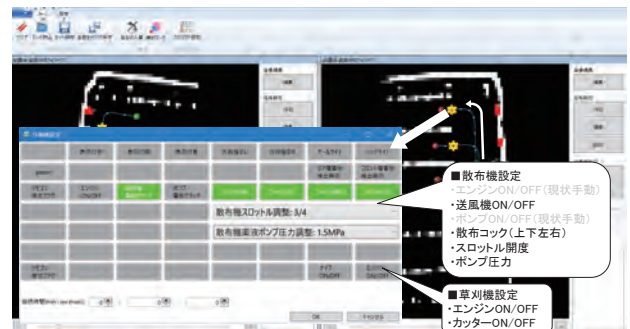
図5 作業機の制御設定
