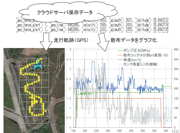
図21 作業データの見える化 (山梨の農薬散布)
