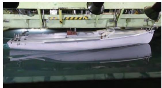
図4 水槽試験の様子 (実艇を使ったヨットの水槽試験は希少な経験となった)
