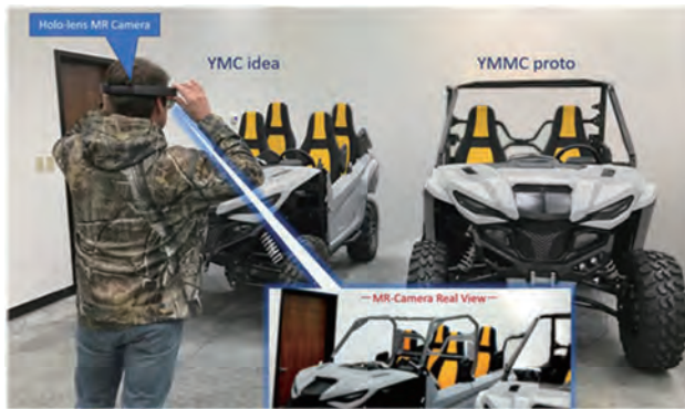
図13 MRカメラを使った外観評価
