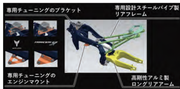
図14 共通フレームと専用設計のリヤフレーム、リヤアーム
