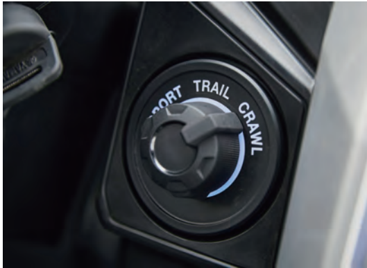
図10 手で切替可能な D-MODE スイッチ
