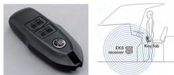
図6 スマートキーとその仕組み
