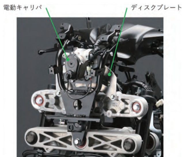
図5 電動キャリパとディスクプレート
