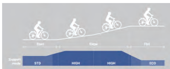
図5 オートマチックアシストモードのイメージ
