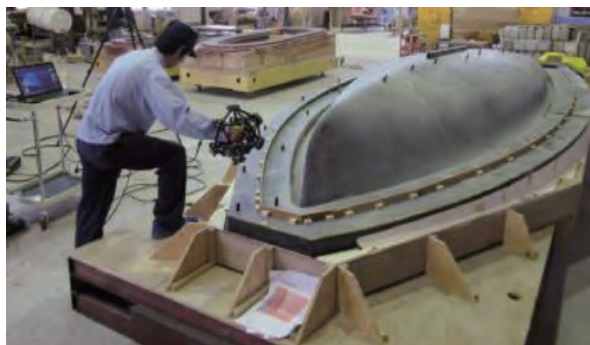
図14 フェアリング後のオ型を3D計測
