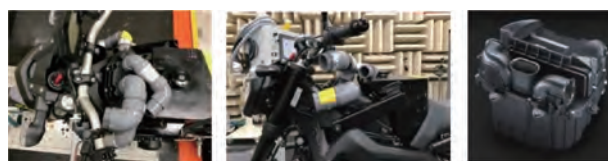
図8 開発中のダクト形状と製品形状
