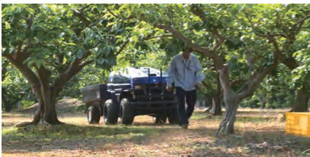
図17 LiDAR を用いた人追従
