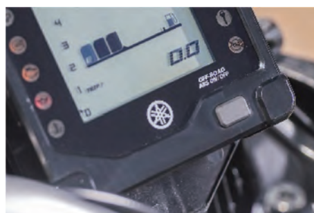
図8 メーター配置の ABS スイッチ
