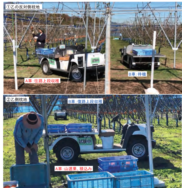
図14 2台連携収穫試験(①②は図13に対応)
