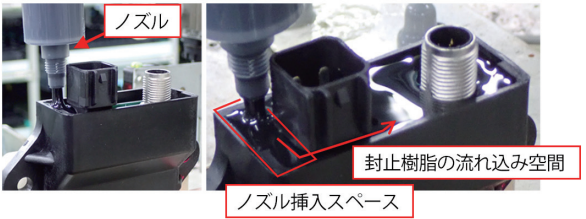
図10 ポッティングによる樹脂封止
