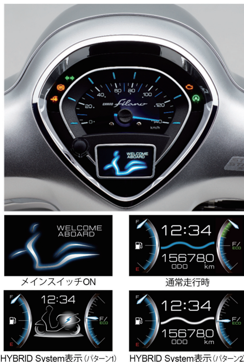
図6 カラーTFTサブモニタ付 新デザインメーター
