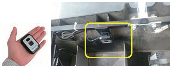
図2 GPS計測器(前席下に設置)
