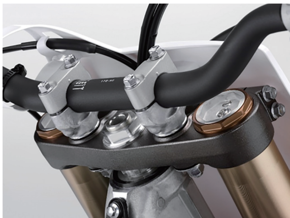
図2 採用されたアルミニウム製テーパーハンドルのテーパー部分拡大
