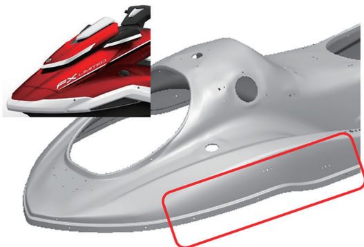
図2 シアラインを変更したガンネルデザイン
