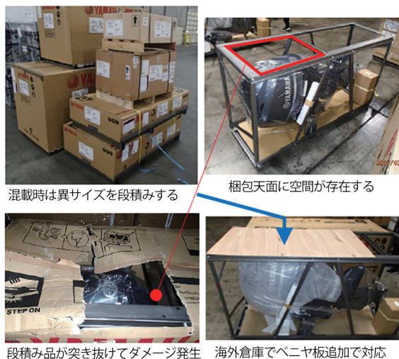
図6 異なるサイズの段積み時の製品ダメージ
