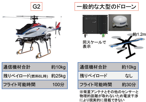
図9 衛星通信機を搭載した場合のペイロード比較
