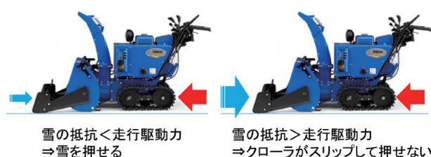
図7 雪の抵抗と走行駆動力
