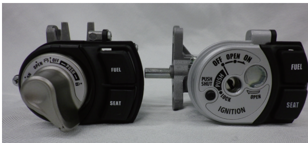
図9 スマートキー式(左図)とキーシリンダー式(右図)のメインスイッチ
