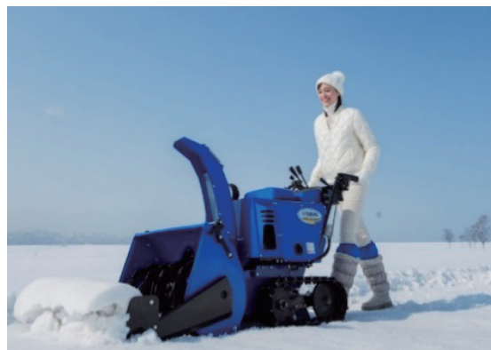
図2 ブレードで雪を押すYS1070T-B
