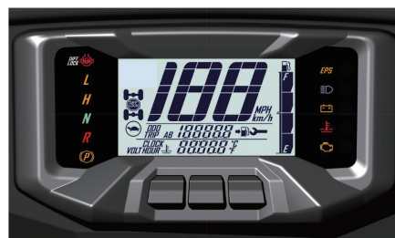
図15 新規開発スピードメーター
