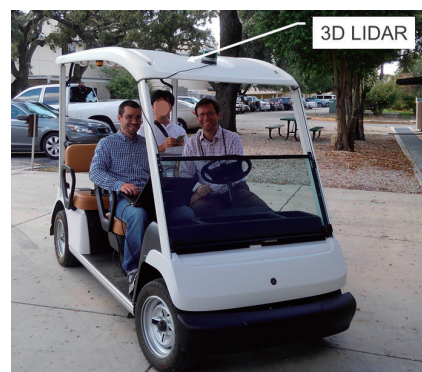
図3 VGL システム搭載、低速自動走行車両
