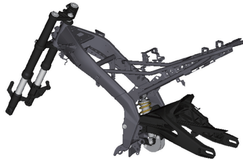
図10 YZF-R15骨格構成
