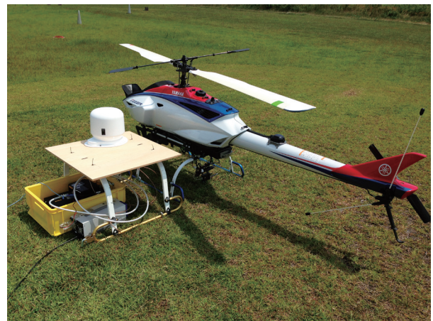
図4 航空機用衛星通信機とFAZERとの通信テスト(初期)
