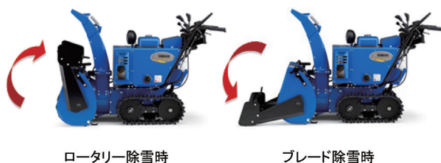
図6 ブレード付除雪機の構造
