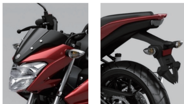
図15 LED化したヘッドライトおよびテールライト
