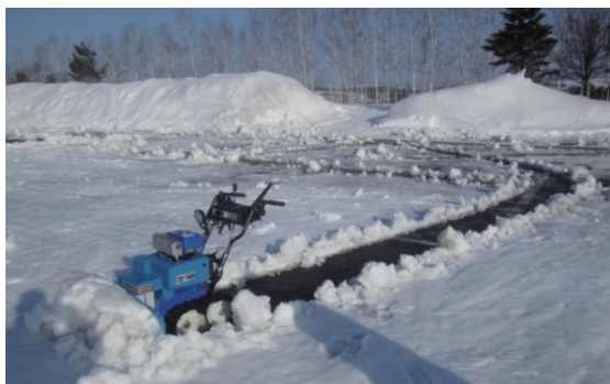
図4 プロット機のテスト風景(北海道士別市) プロット仕様:YT660をブレード除雪機に改造
