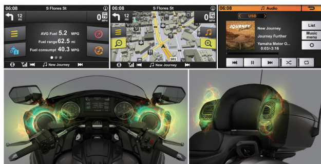
図3 インフォテインメント（上：画面例、下：スピーカー）
