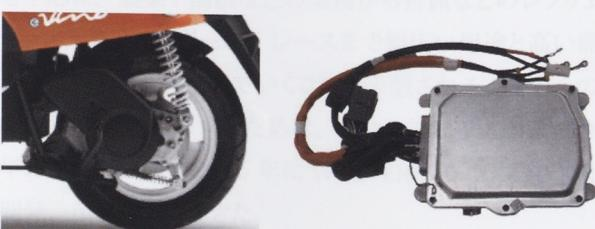
図8 パワーユニット、モーターコントロールユニット
