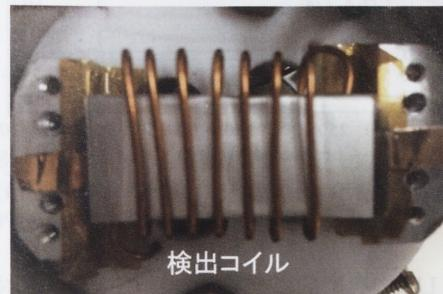
図3 電池NMR用扁平巻き検出コイル
