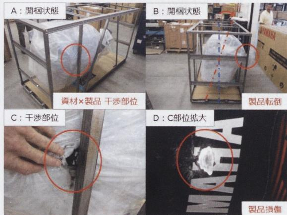
図3-1 梱包資材破損による製品破損
