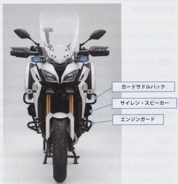
図2 全幅を抑えたガード、サイレンのレイアウト
