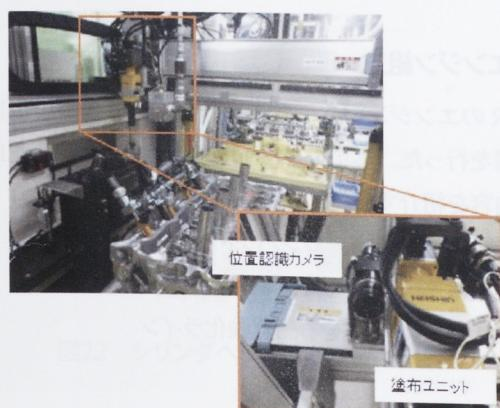
図28 画像補正機能付き液体ガスケット塗布機
