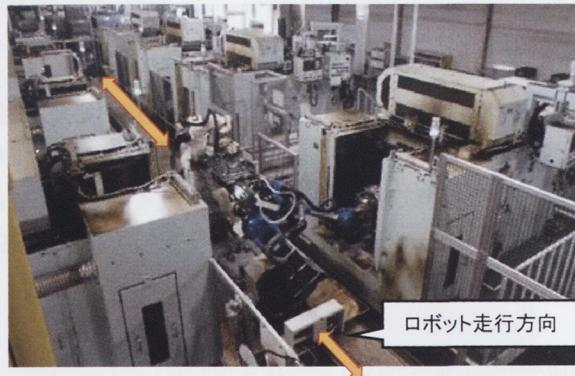
図23 シリンダーブロック加工ライン 多関節ロボット搬送
