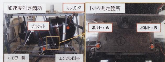
図4-1 加速度とトルクの測定箇所
