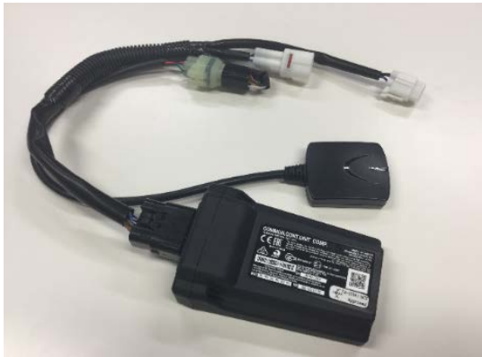
図2 車載されるCCU、GNSS アンテナ、専用ハーネス
