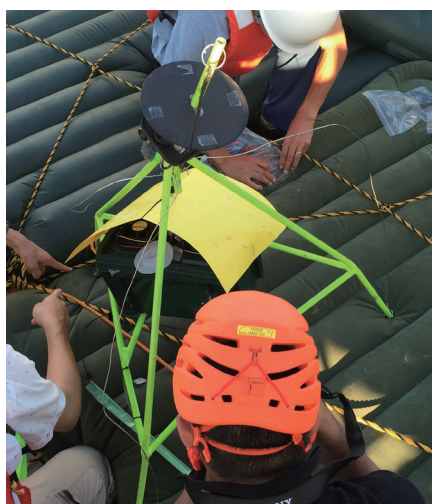
図10 島に設置3日後に回収した360°視野カメラ
