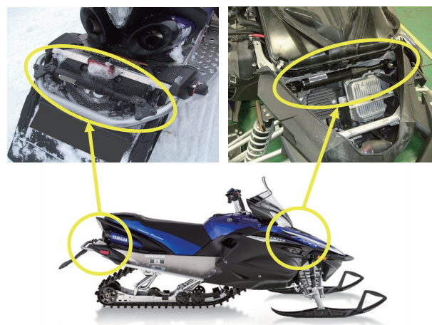
図9 スノーモビルへのPD取り付け例
