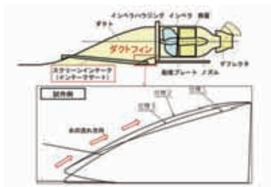
図 10 スクリーンインテークとダクトフィン形状
