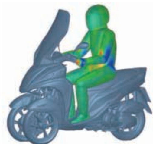
図8 CFD解析によるハイスクリーン開発
