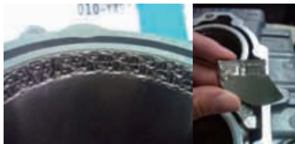
図10 主軸剛性の影響（びびり）
