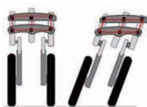
図3 平行四辺形リンクの挙動
