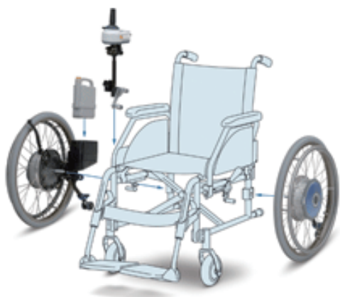
図3 車いす用電動化ユニットの構造 [3]
