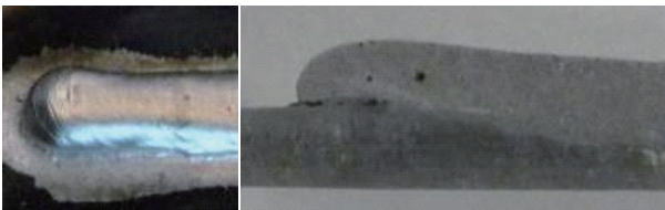
図2 従来 MIG 溶接始点のビード外観と溶け込み
