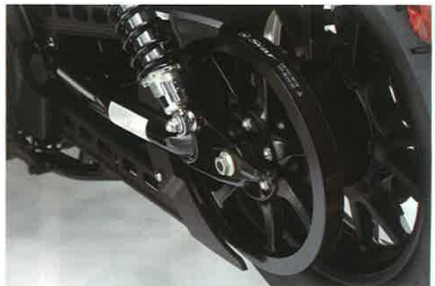
図8 幅狭カーボンベルト
