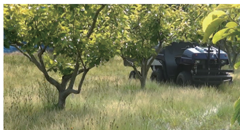
図2 下草や枝葉が茂る果樹園で樹幹との位置関係を認識し自律走行(最大5m/s)
