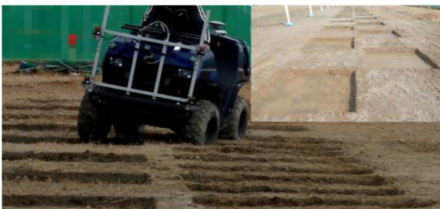
図5 左右輪で位相が異なる深さ15cmの 凹凸路面で経路追従実験(最大3.5m/s)
