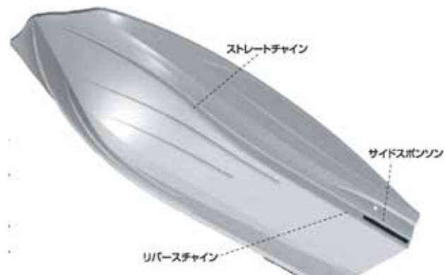
図9 ストレートチェーン形状
