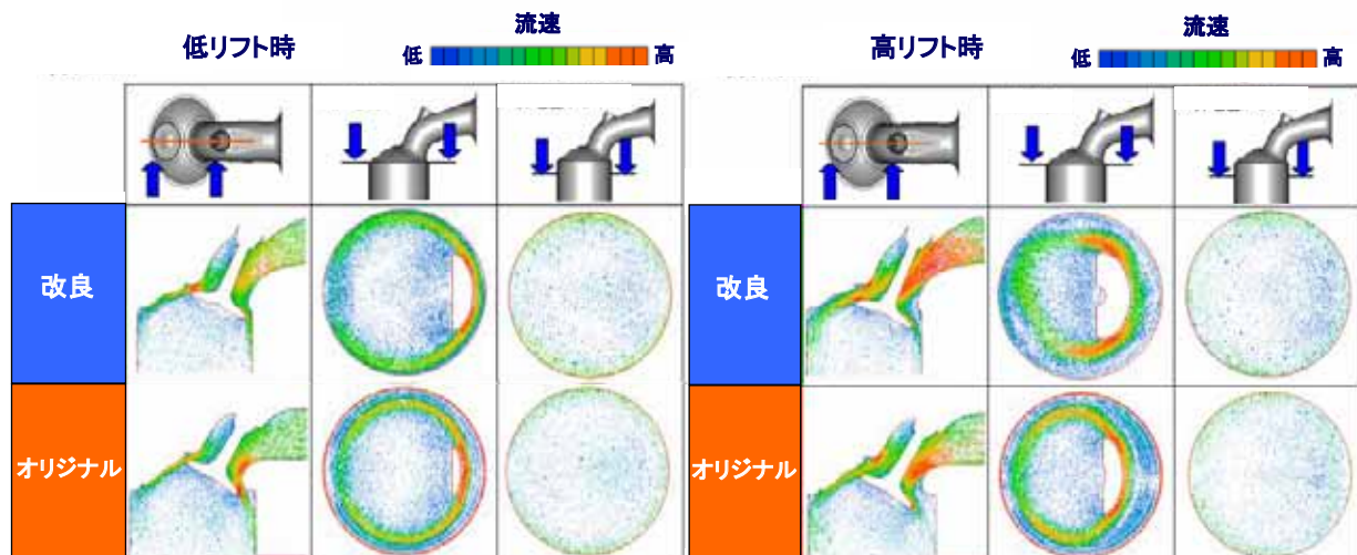
図1 YM-JET FI 改良による筒内流動強化の様子
