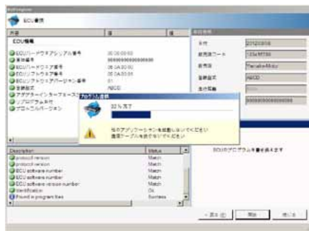
図 10 コントロールユニットプログラム書換
