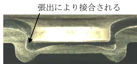
図3-2 メカニカルクリンチ断面
