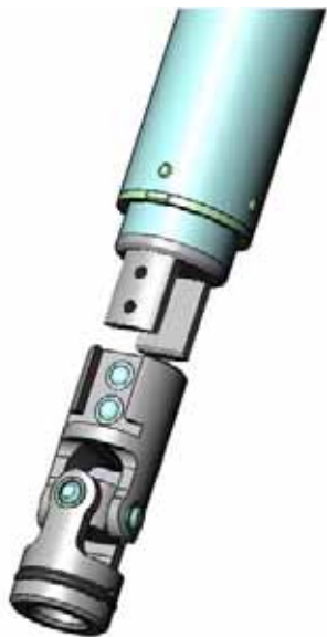
図8 R軸脱着構造
