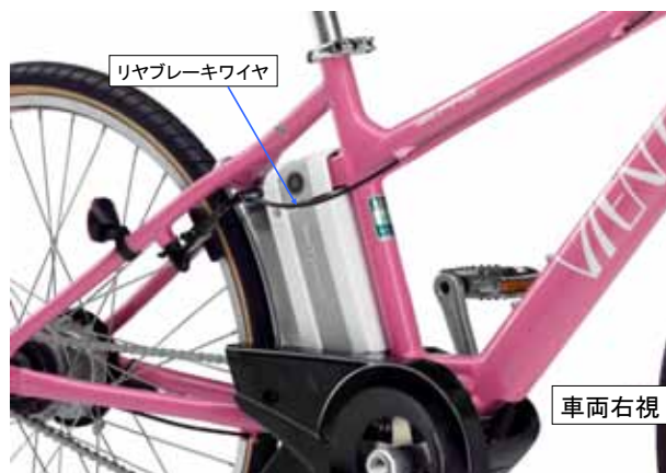
図11 リヤブレーキレイアウト（製品）
