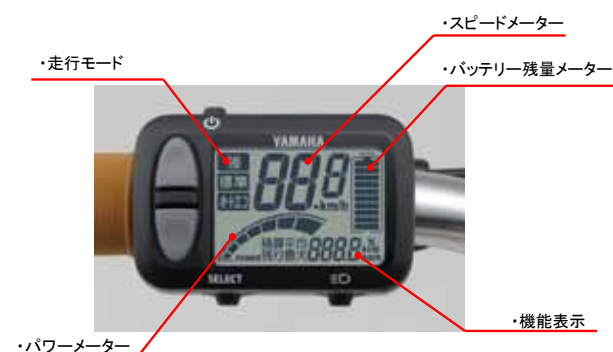
図3 液晶マルチファンクションメータの外観と機能
