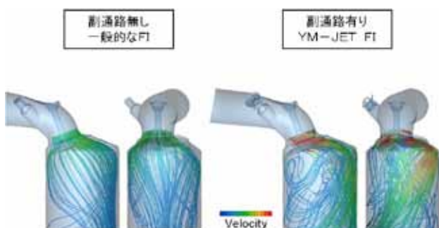
図5 YM-JET FI の効果(副通路有り無しによる筒内流動の差)
