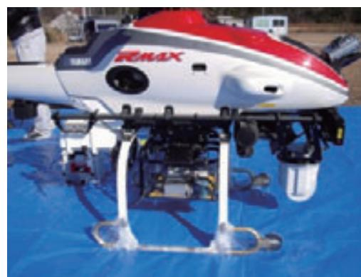
図 5 測定装置搭載状態
