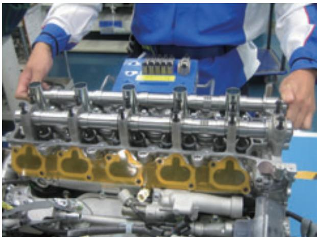
図 10 ダミーカムシャフトによる芯出し
