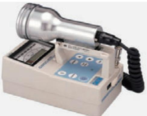
図 4 GM 管式サーベイメーター
