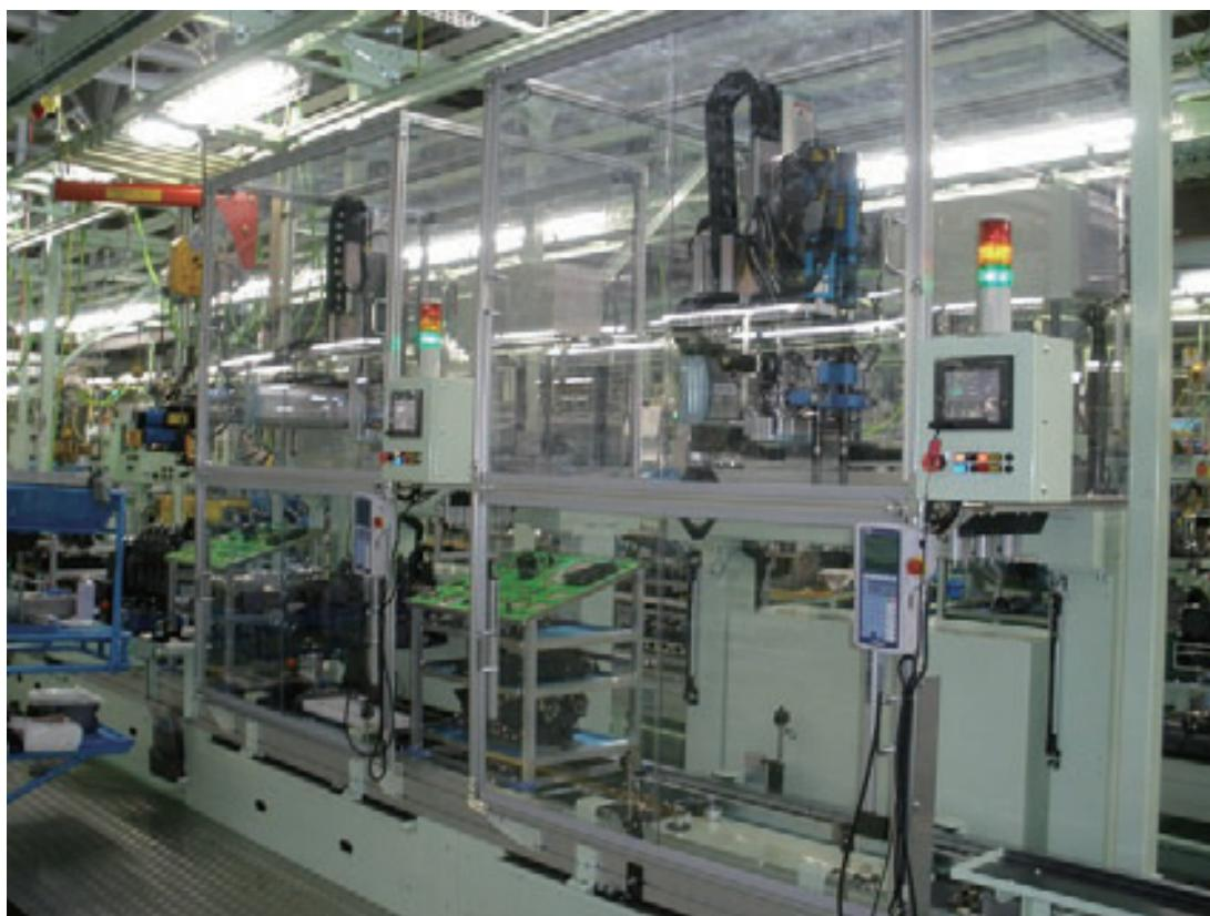
図2 自動ねじ締め装置
