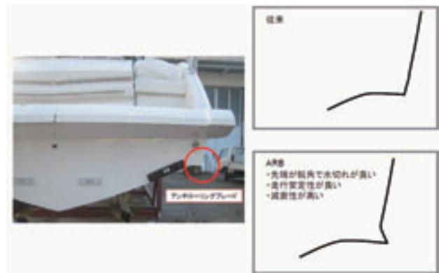
図5 EXULT36 アンチローリングブレード
