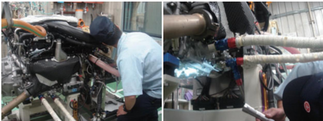
図 16 聽感検査と目視検査
