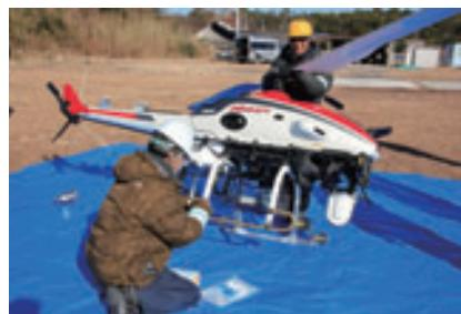
汚染防止のために、機体接地点であるスキッド部分に養生を実施。
