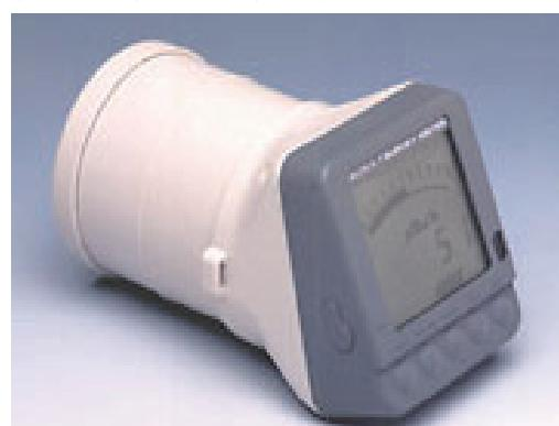
図 3 電離箱式サーベイメーター
