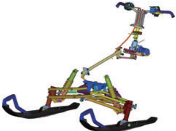
図4 ステアリング構成図
