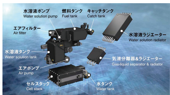
図 5 DMFC システムレイアウト
