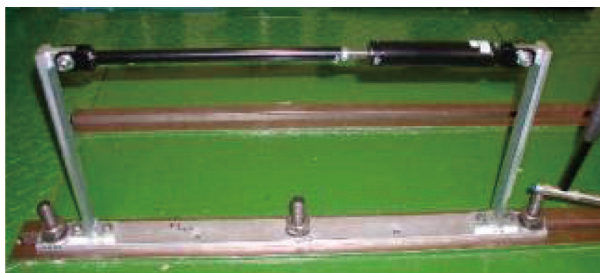
図7 100Hz 振動テストピース (PD 有での計測状態)
