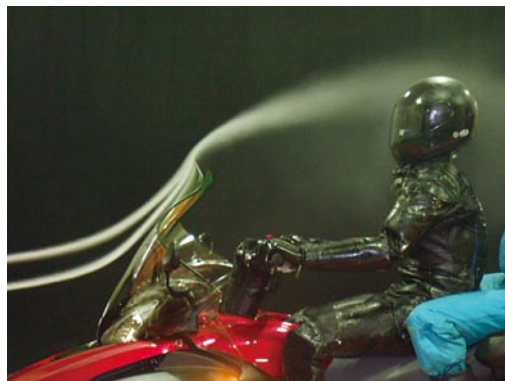
図8 ウィンドプロテクション実験風景
