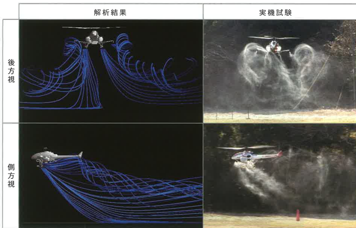
図7 解析結果と実機試験の比較
