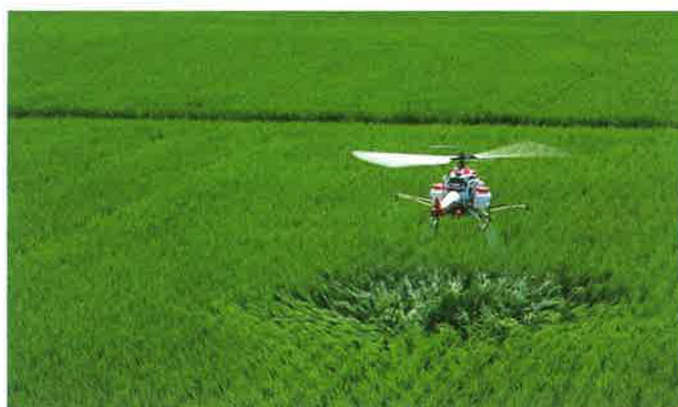
図1 RMAX を用いた薬剤散布
