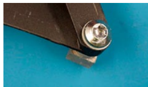
図 14 塩水噴霧試験後の締結部外観
