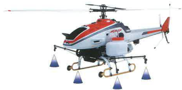
図2 機体に装着した液剤散布装置
