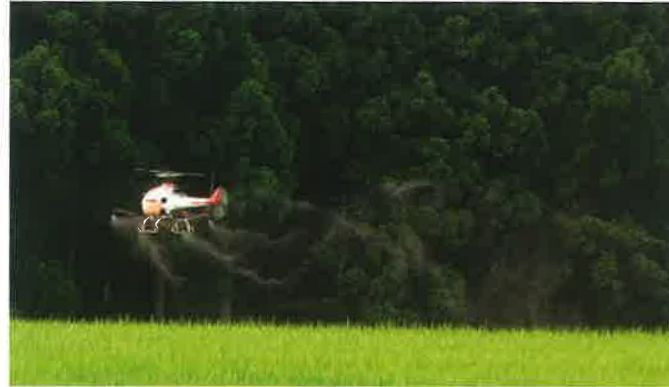
図3 機体後方に後流渦を引く様子
