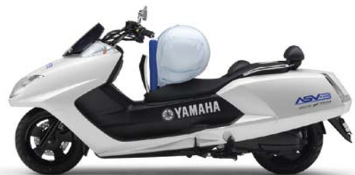
図7 ASV-3のエアバッグ
