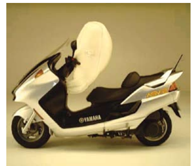
図6 ASV-2のエアバッグ
