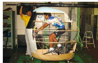
図6 操縦席のカーボンフレーム構造
