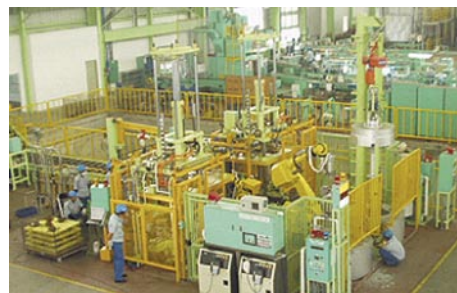
図2 キャストホイール重力鑄造ライン(インドネシア)
