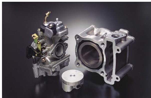
図7 ダイアジルシリンダー、鍛造ピストン、キャブレター
