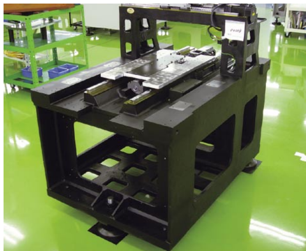
図5 3本足で支持された一体構造高剛性鋳造ベッド
