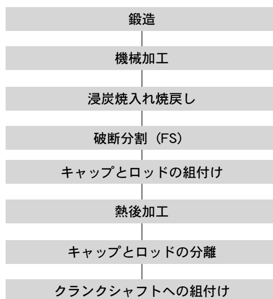
図3 FS浸炭コンロッドの製造工程
