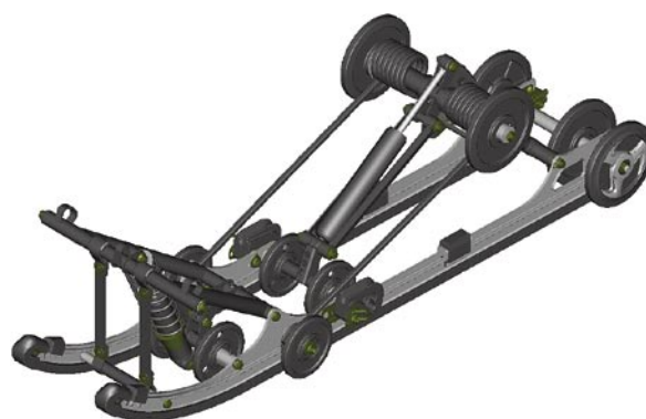
図12 プロコンフォート・リアサスペンション
