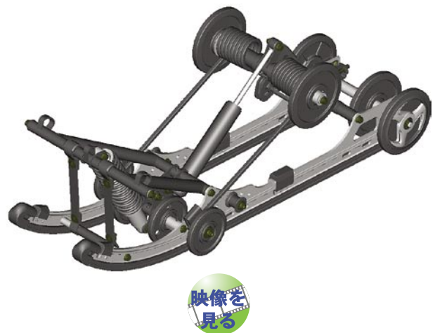
図10 プロアクティブ・リアサスペンション
