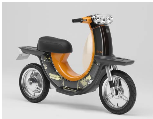
図 6 DMFC を搭載したコンセプトモデル "FC06"
