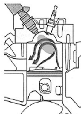
図 4 HPDI 作動原理
