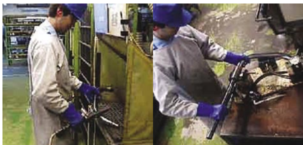
図5 曲げ傷修正工程
