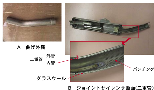
図 13 ジョイントサイレンサ曲げ外観、断面
