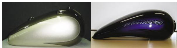
図8 従来のタンク（左）と Road Star Warrior の薄型タンク（右）
