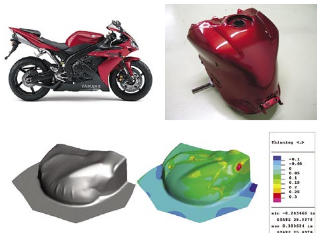
図9 YZF-R1(2004) 車体とタンク、解析結果画像
